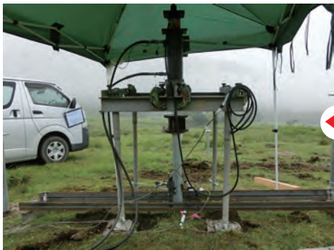
長期耐力引抜試験
