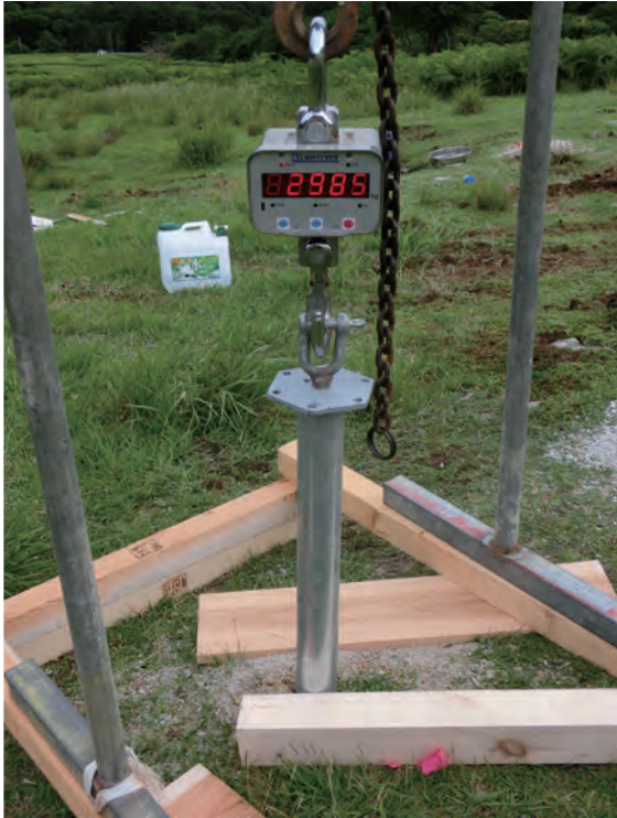
引抜試験 2,985Kg/ 杭 1 本 (外径 76 mm、打込み 1,600mm)
